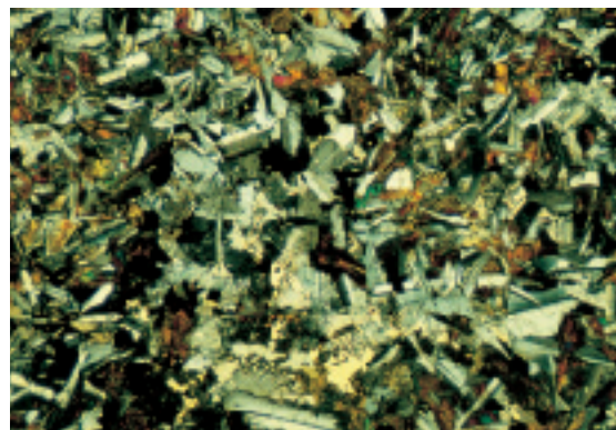
Diabasa. Làmina prima en microscopi petrogràfic. 15x.
