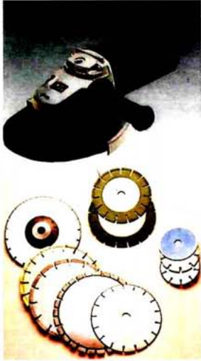
Máquina radial de corte en seco que se emplea en el proceso de desbaste. Distintos tipos de discos de diamante electrodepositado.
